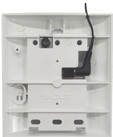
<Задняя сторона> Подключение адаптера
